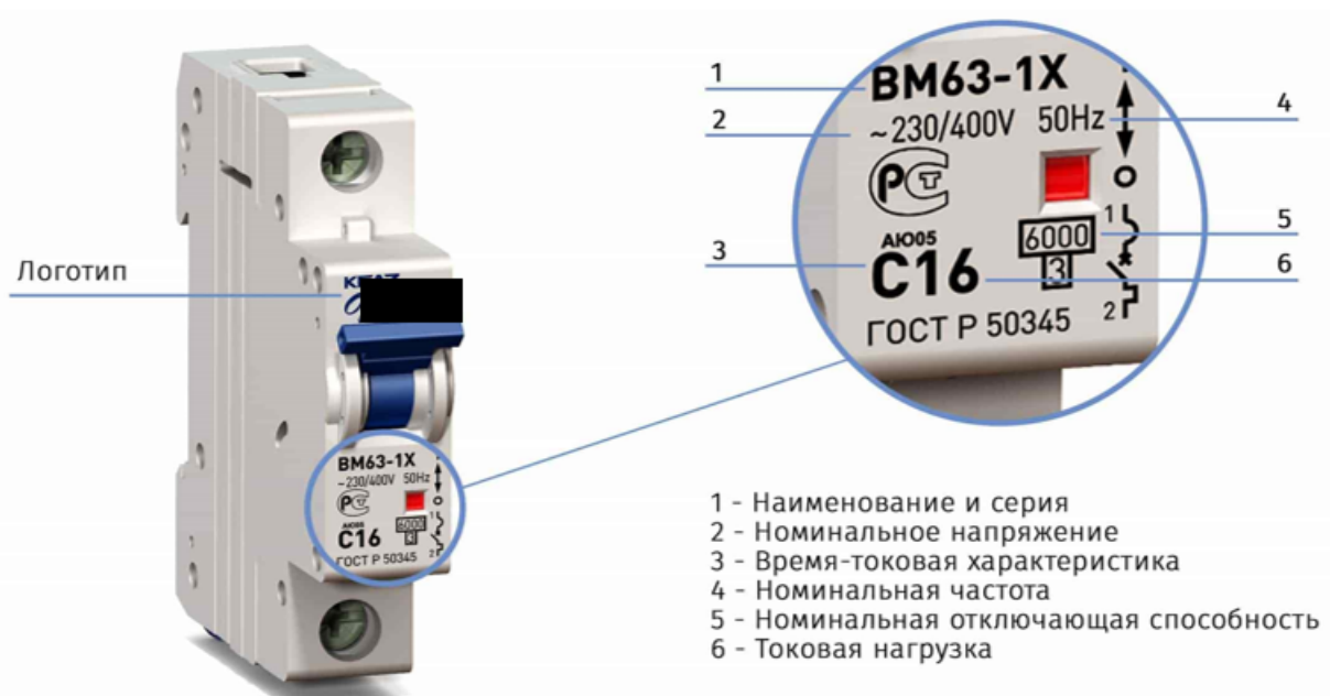
Рисунок 2. Пример маркировки АВ
